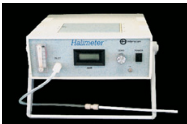
FIGURA 1 – Monitor portátil de sulfetos (Halimeter™).
